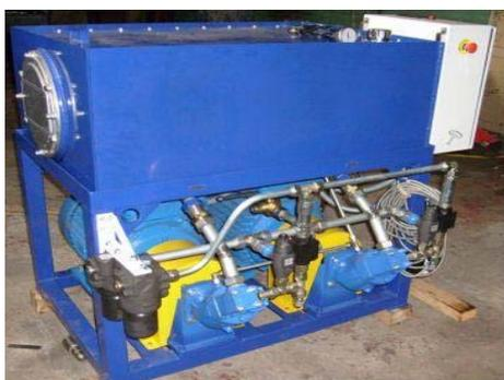
**УН с двумя насосными узлами** для испытаний авиационных агрегатов и приводов. Мощность установки 2x37 кВт, рабочее давление 250 бар, объем гидробака 400 л.
