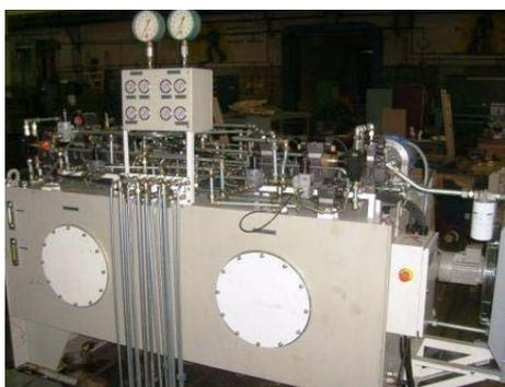
**Установка насосная (УН) для специального станочного оборудования**
