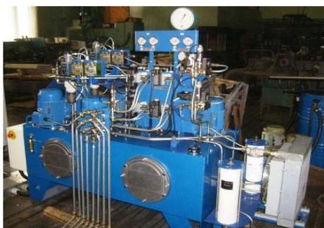
**УН для специального станочного оборудования с гидроуправлением**
